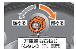
締付けを行った後も、ナットがたびたび緩むなどの異常がある場合は、必ず、ホイールを取外して点検・整備を実施してください。ディスクホイールやハブなどに異常がある可能性があります。
